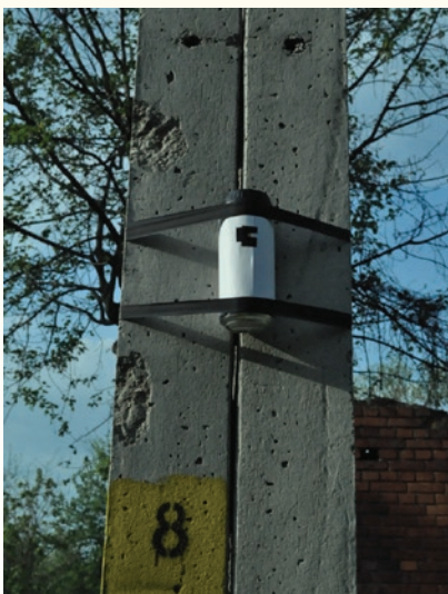
Rys. 1. „Aparat solarygraficzny” zainstalowany na słupie energetycznym
